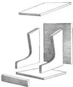
3. Assemblez les pièces selon le plan de construction, à l'aide de vis revêtues à tête plate de 4 cm. La structure durera plus longtemps si vous renforcez les joints avec de la colle à adhérence instantanée.
